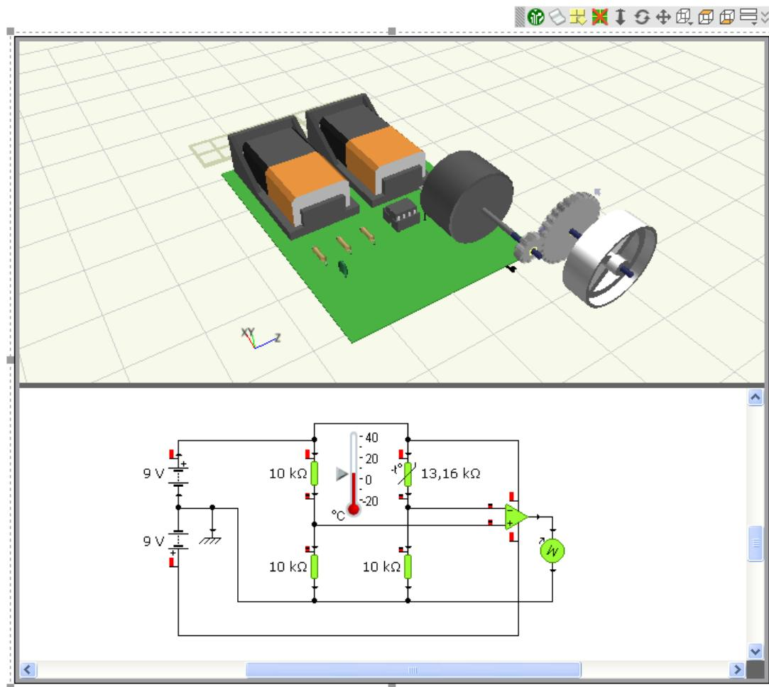
Permite crear un circuito para controlar la velocidad del motor de acuerdo al aumento o disminución de la temperatura.
