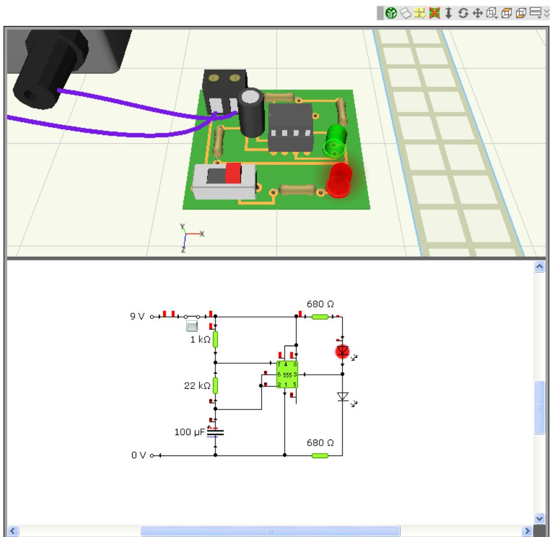
El anterior circuito me permite crear luces intermitentes utilizando el circuito integrado 555 (Timer 555).
